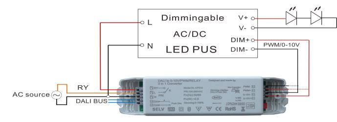
\*DL-CP010内置的继电器可以控制LED驱动电源的开关。
